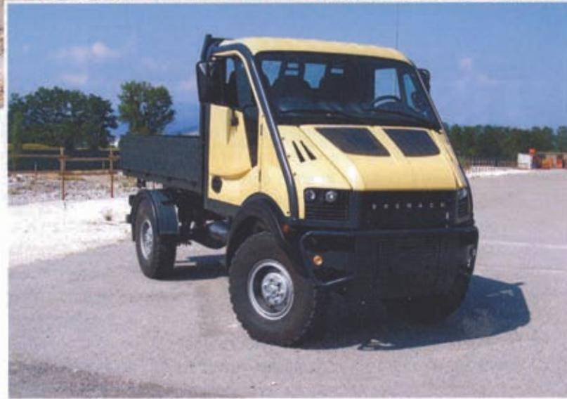
245/70 RI7,5 per portata da 6,0t. Date le sue specifiche caratteristiche di robustezza possiamo produrre il nuovo T-Rex con tre passi differenti, 2.600, 3.100 e 3.450 mm. La pendenza massima superabile è di 45° e le prese di forza sono dal cambio con coppia massima prelevabile di 180 Nm a 1.500 rpm, mentre la seconda dal riduttore ha una coppia massima di 150 Nm a 1.900 rpm".
