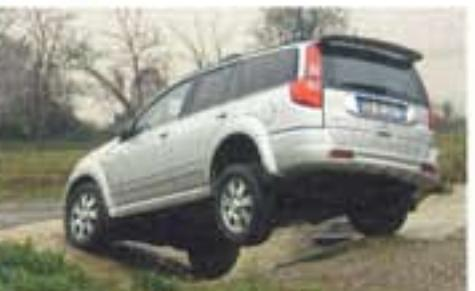
In teoria, bastano due ruote sollevate (una per asse) per fermare la «Hover», che non dispone di differenziali bloccabili. In realtà, grazie all'escursione ampia delle sospensioni, la Great Wall supera il nostro test perché riesce a mantenere almeno tre ruote in presa. Apprezzata anche la modularità della frizione.
