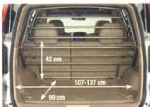
Queste sono le misure del bagagliaio rilevate dal nostro Centro prove. La capacità del vano della versione autocarro, quella in prova, è di 495 litri: la paratia fissa, imposta dal Codice della strada, non consente di sfruttare opportunamente l'abbattibilità degli schienali posteriori.
