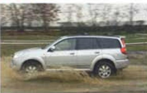
La distanza minima dal suolo è abbastanza elevata: noi abbiamo misurato oltre 21 centimetri, sufficienti per viaggiare su fondi particolarmente accidentati, ma anche per superare pozzianghere profonde. La posizione degli impianti di aspirazione e scarico garantisce un adeguato margine di sicurezza.
