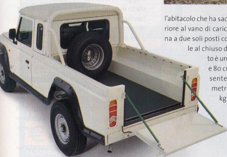
l'abitacolo che ha sacrificato la parte posteriore al vano di carico e ha ridotto la cabina a due soli posti con un po' di spazio utile al chiuso dietro i sedili. Il risultato è un cassone lungo 1 metro e 80 cm e largo 1,50, che consente di caricare fino a 1,5 metri cubi di merce e 1.000 kg di carico utile. Assolutamente tradizionale l'impostazione meccanica che ricorda mezzi di una ventina d'anni fa. Il motore è un 4 cilin-
